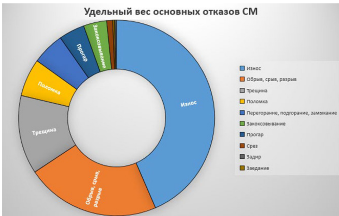
Рис. 1. Диаграмма удельного веса основных видов отказов СМ при эксплуатации на Крайнем Севере (износ – 39,8 %, обрыв, срыв, разрыв – 20,3 %, трещина – 11,9 %, поломка – 5,7 %, перегорание – подгорание, замыкание – 4,9 %, закоксовывание – 3,5%, прогар – 3,9 %, срез – 0,9 %, задир – 0,3 %, заедание – 0,3 %)
